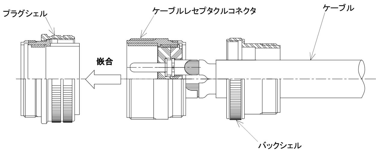
5-11. バックシェルとケーブルクランプボディを締め付けます。
