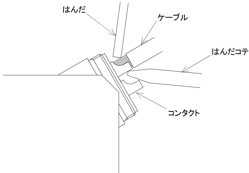
5-10. ケーブルレセプタクルコネクタにバックシェルを取り付けます。
